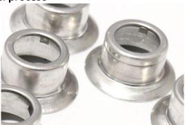
Las herramientas principales de la embutición profunda son un punzón y un troquel o molde. El punzón debe ser diseñado con la forma de la base en la parte inferior de la pieza.
